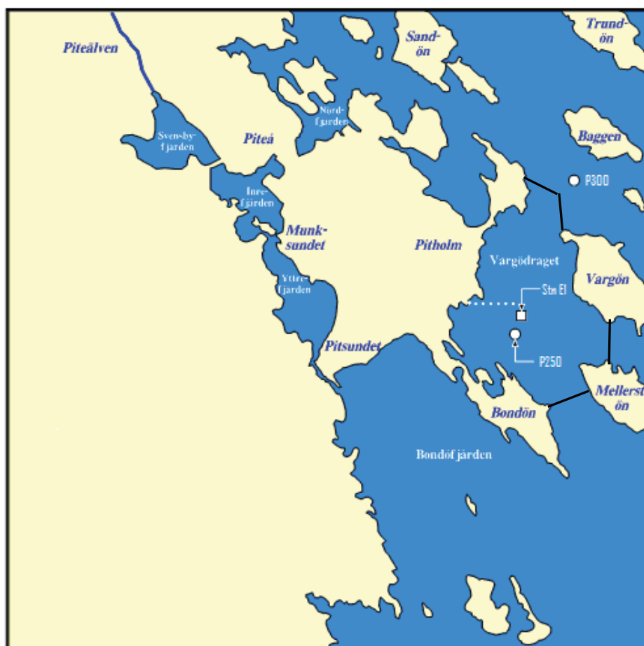
Figur 13 Kartskiss över recipienten avgränsad med svarta heldragna linjer. Kraftliners avloppsvatten pumpas via en avloppstub (vitstreckad linje). P250 är provtagningsstation för vattenkemi. E1 är provtagningsstation för sediment och bottenfauna. Modifierad från SBR (2001).
